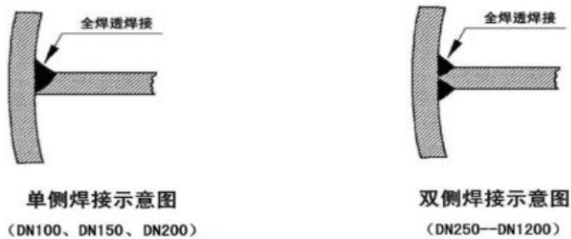
图3：清管三通挡条与支管的焊接示意图
